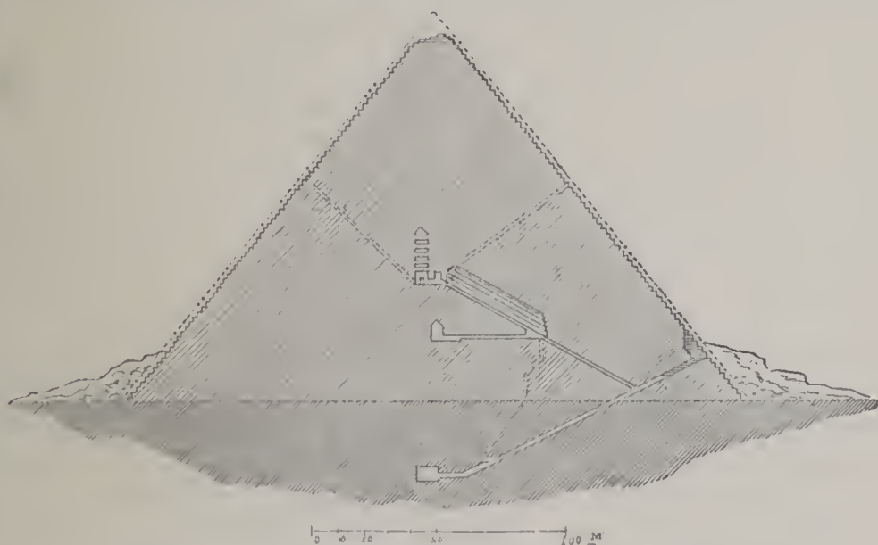
Fig. 5. Chufu-Pyramide. Durchschnitt. (Nach Perring.)
